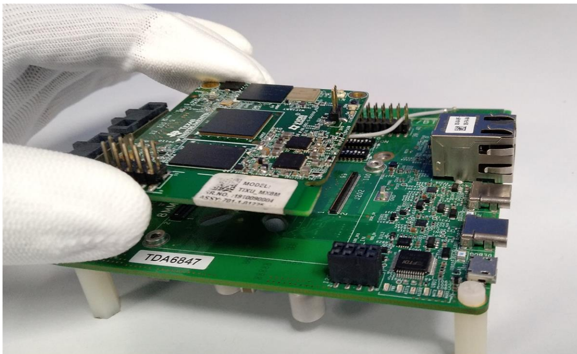
Figure 17. Screwing SoM Board to Base-board
